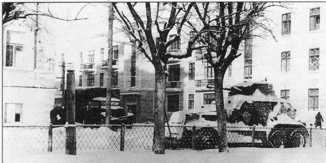
Бронеавтомобиль шведского производства «Ландсверк-181», ранее принадлежавший голландской армии, бронированный германскими войсками в Калуге. На борту машины нанесена эмблема германской полиции. Зима 1942 г.
