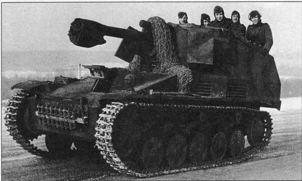
105-мм САУ «Веспе» на юго-западном участке советско-германского фронта. Имеет камуфляж в виде зеленых пятен-полос поверх базового Schwarzgrau. Весна 1943 г.
