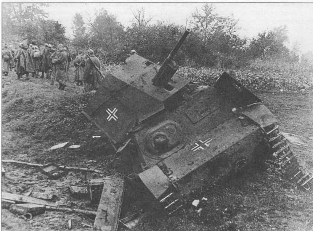
Германская импровизированная 37-мм САУ на базе советского тягача «Комсомолец». Окрашена в серый цвет, на увеличенных щитах «рубки» и корпусе нанесены белые кресты. Киевское направление, село Смоляк. Сентябрь, 1943 г.
