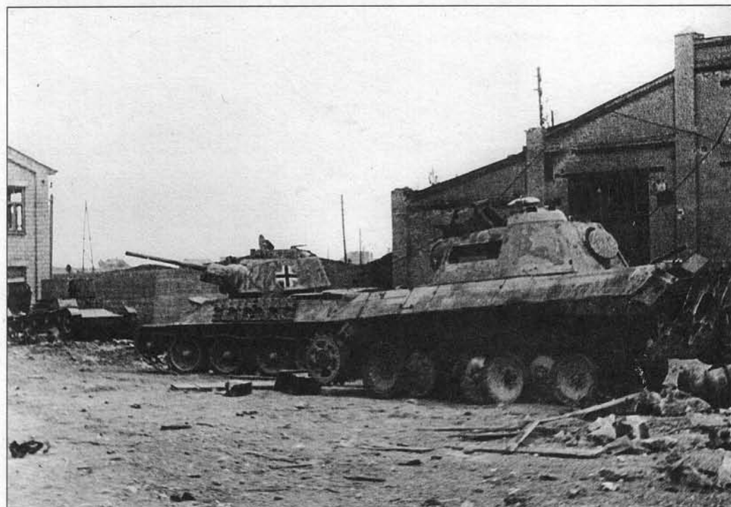
Танки Т-26 обр. 1931 года, Т-34/76 и PzKpfw V «Пантера» германской армии во дворе завода «Большевик» в Минске. Танки покрашены в Dunkel Gelb с нанесением на него зеленых, а возможно и коричневых пятен-полос. 3-й Белорусский фронт. Июль, 1944 г.
