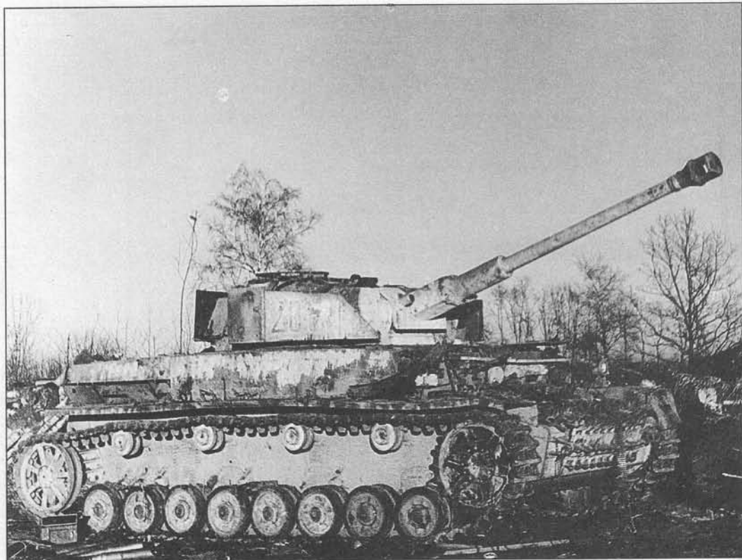
PzKpfw IV Ausf H, покрытый циммеритом и имеющий номер 201. Германия, март 1945 г.
