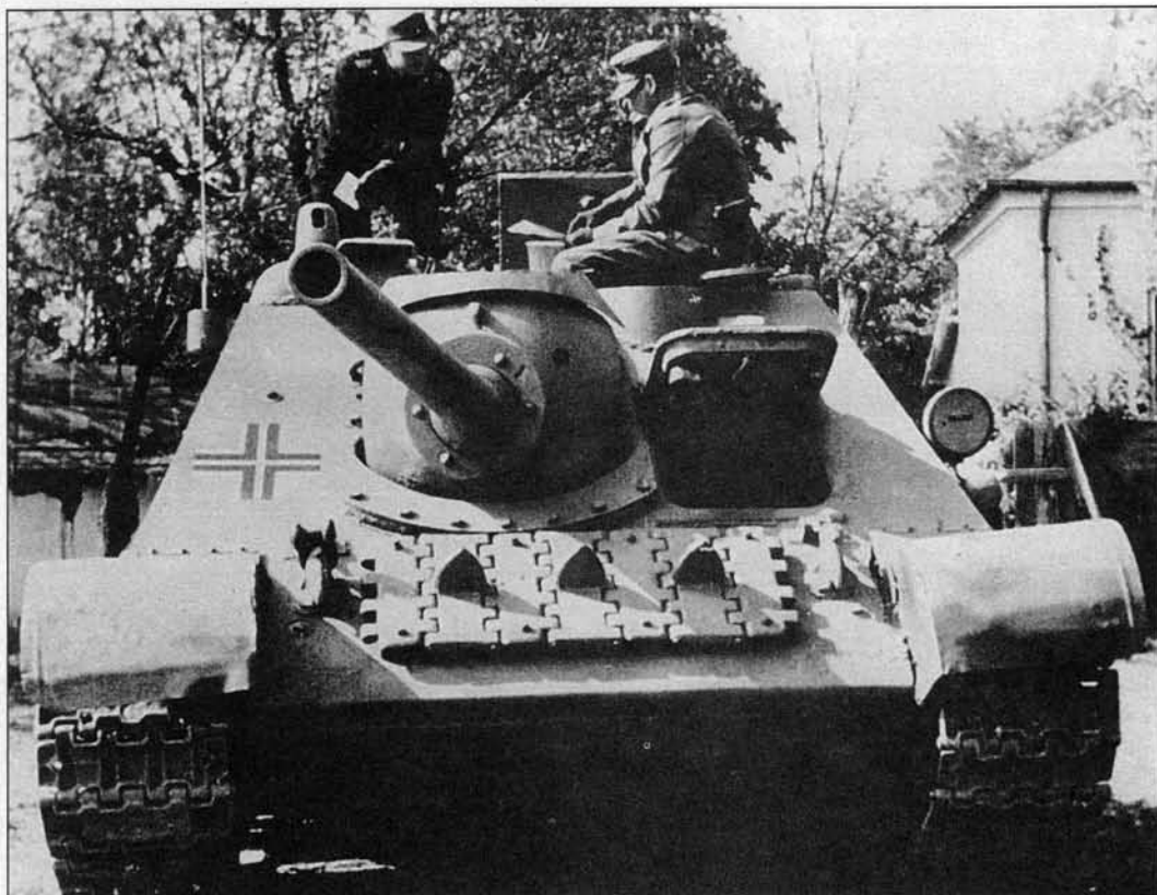
Трофейная советская САУ СУ-85. Окрашена Dunkelgelb с нанесением германских опознавательных знаков. Советско-германский фронт. Лето, 1944 г.
